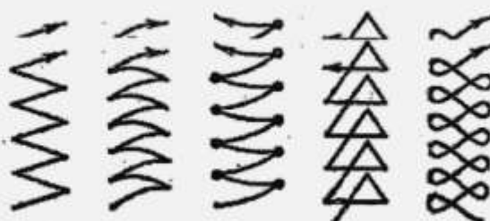
Рис. 5. Траектория движения конца электрода при ручной дуговой сварке.
