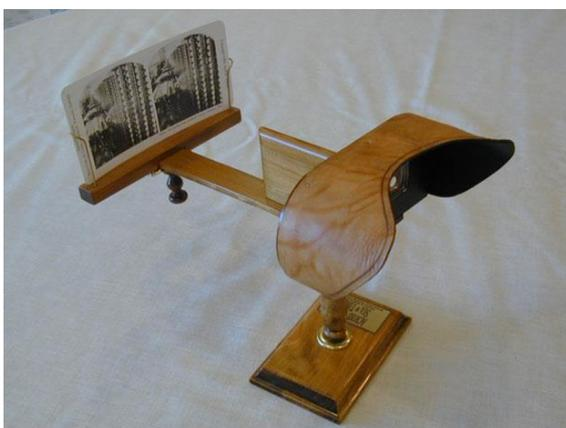
**Рис. 1.1.** Стереоскоп - устройство для просмотра стереоизображений
