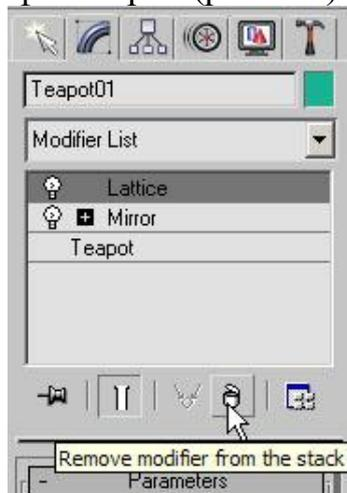
**Рис. 4.3.** Кнопка для удаления примененного ранее модификатора
