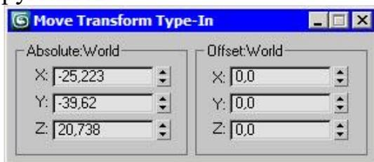
**Рис. 3.11.** Для ввода точных значений можно использовать окно Move Transform Type-In (Ввод значений перемещения)
