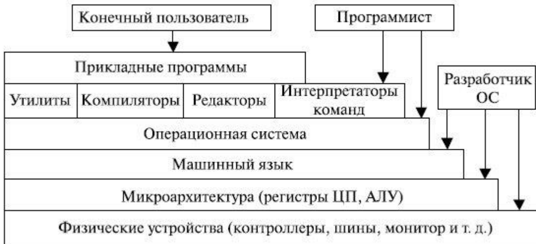
Рис. 1.1. Иерархическая структура программно-аппаратных средств компьютера
