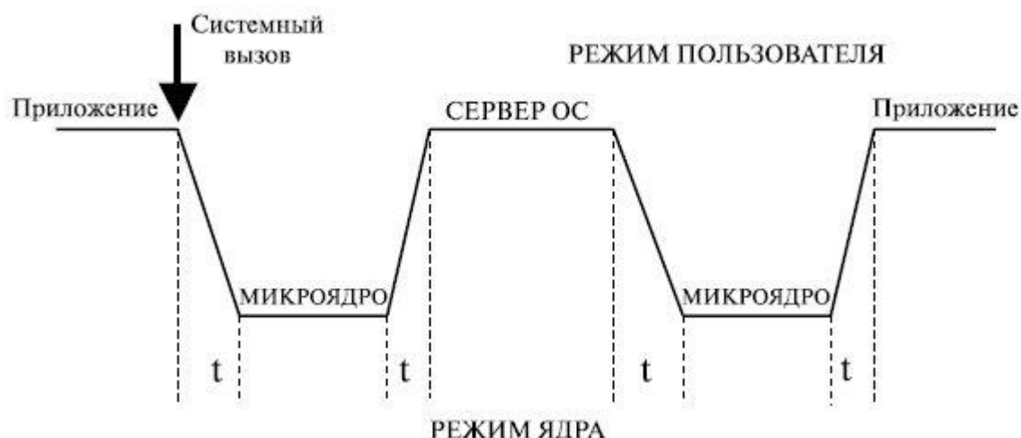
Рис. 1.8. Обработка системного вызова в микроядерной архитектуре
