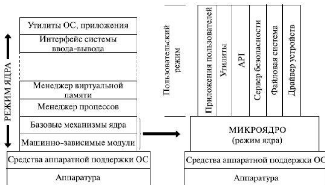
Рис. 1.6. Переход к микроядерной архитектуре
