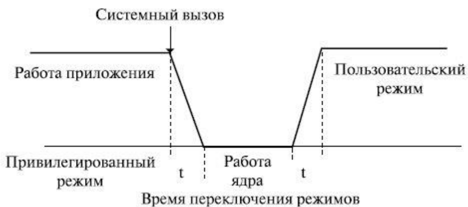
Рис. 1.5. Обработка системного вызова
